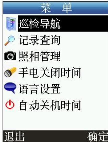
① **巡检导航**。可以查看到巡检线路中所有巡检点，引导巡检员巡检顺序，防止漏检
