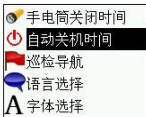
**A 手电筒关闭时间**。可设置 10 秒、15 秒、30 秒、1 分钟、2 分钟，5 分钟，上、下键选择时间，电源键确定并退出，不选择可按“退出”键退出。**注：在主界面，“上”键开启手电筒功能，“下”键关手电筒。**
