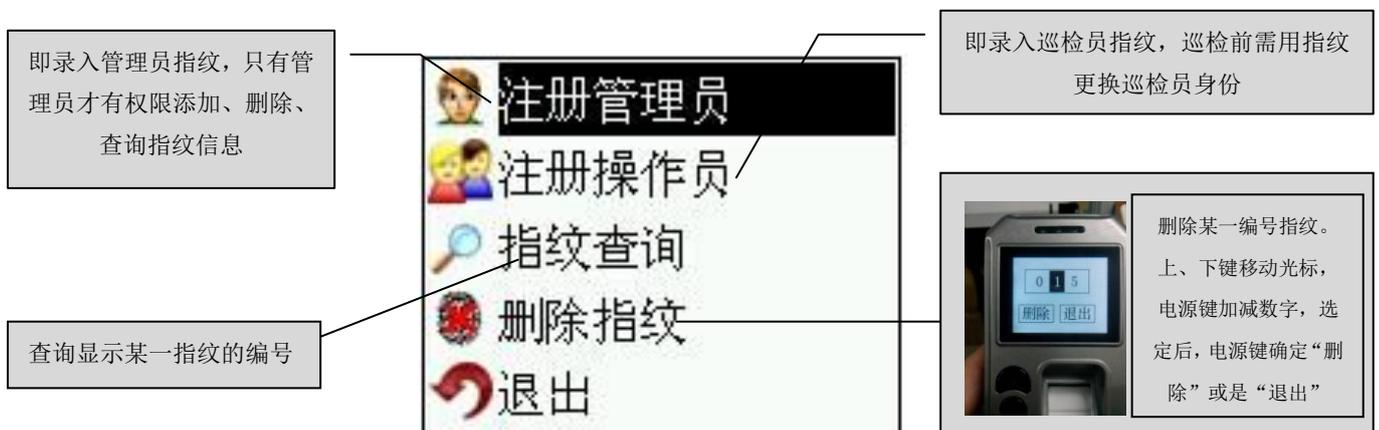
③**指纹更换操作人员**。巡检员巡检前录入指纹更换操作员，更换成功屏幕会提示“人员已更换”并显示更换的巡检员姓名。指纹错误会显示“无此指纹信息”，LED 红灯闪 3 次，同时有 3 次“哔”声提示，然后出现“请重按手指”。当第三次指纹录入还不成功时，系统会提示“次数超限，请重试”，这时需返回上一界面，重新按键进入指纹更换界面。
