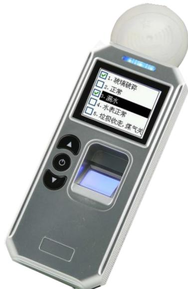
**注：**当巡检员读到巡检点后，事件模式为一时，选择一个事件后，按电源键即保存退出。事件模式为三时，按上下键可选择事件，按电源键为选中，选中后按退出为保存并退出，若不选择事件直接退出，默认选择第一个事件。事件是通过系统软件设置后，上传到巡检机。
