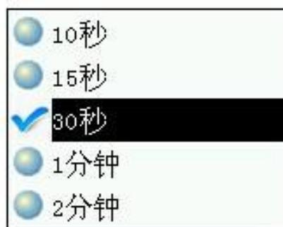
**B 自动关机时间**可设置 10 秒、15 秒、30 秒、1 分钟、2 分钟，5 分钟，上、下键选择时间，电源键确定并退出，不选择可按“退出”键退出。**注：当机器停留在非主界面时，系统将自动逐级返回主界面，然后在设定的时间关机。**
