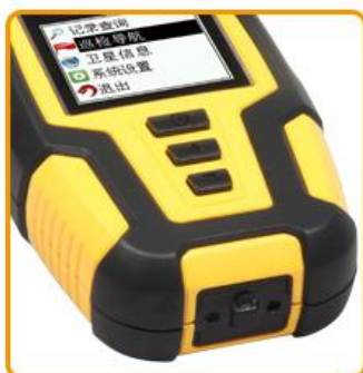
SIM 卡巡检数据实时发送
